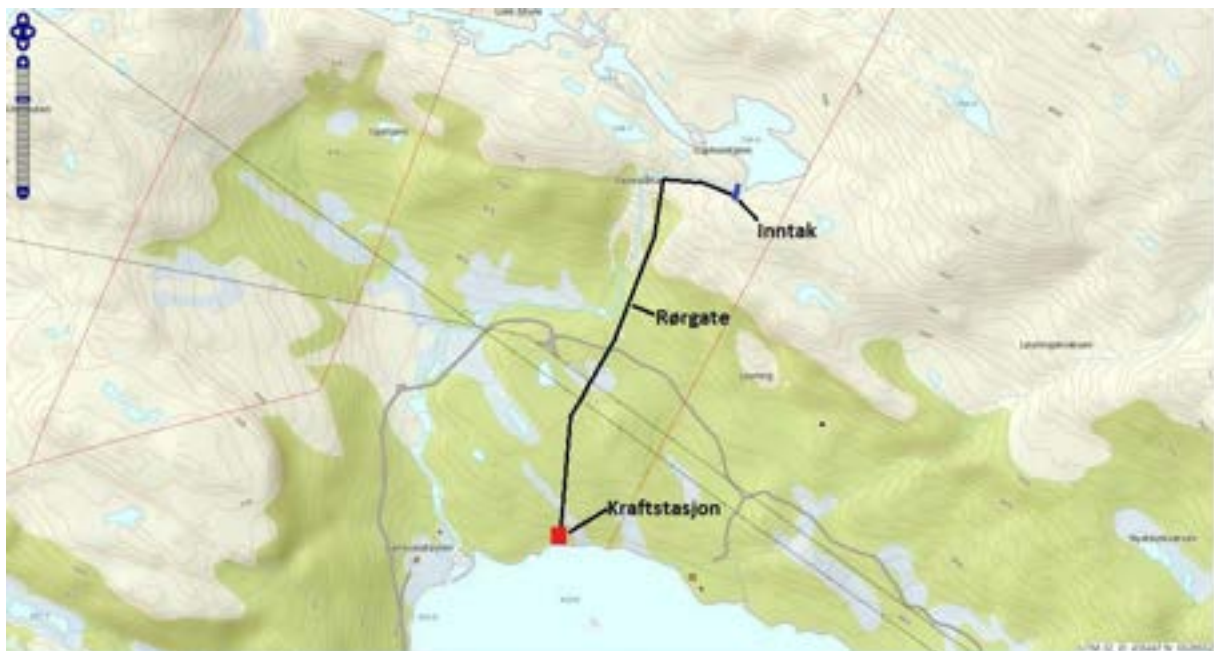
Figur 1: Viser plassering av inntak, vannvei og kraftstasjon for Osphom kraftverk. Kartgrunnlag: Kilden
